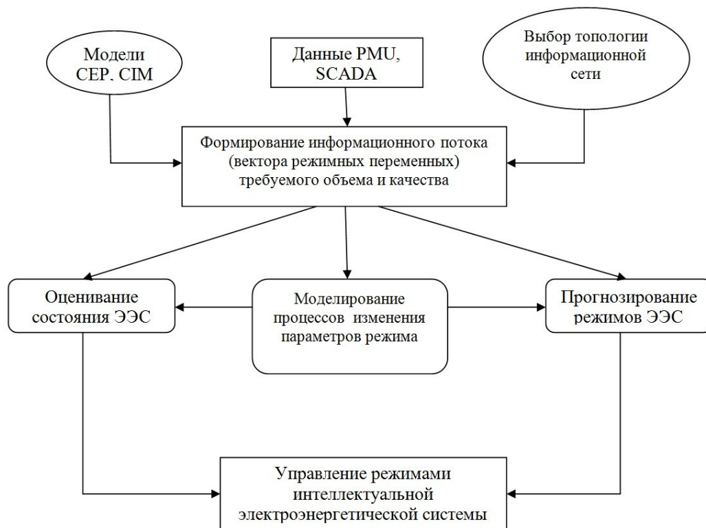
Рисунок 20. Общая схема обработки информационных потоков при мониторинге и управлении режимами интеллектуальной ЭЭС
