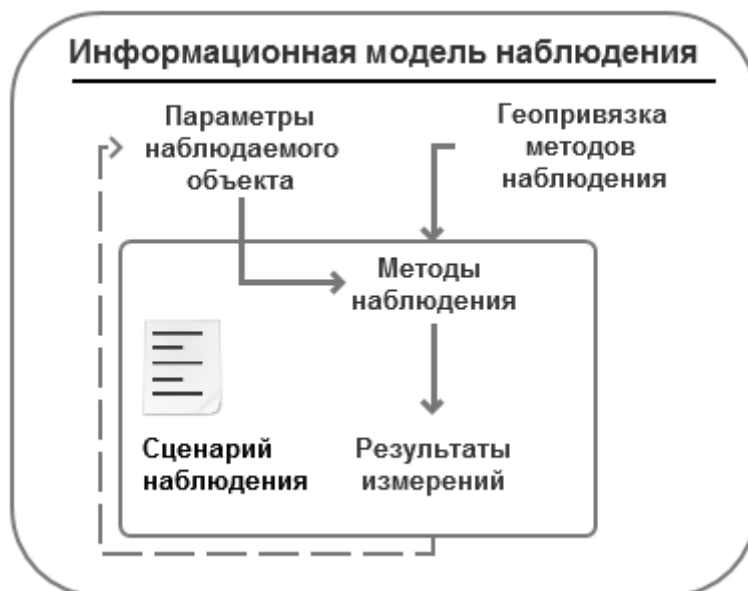
Рисунок 7. Информационная модель наблюдения за пространственно-недоопределенным объектом
