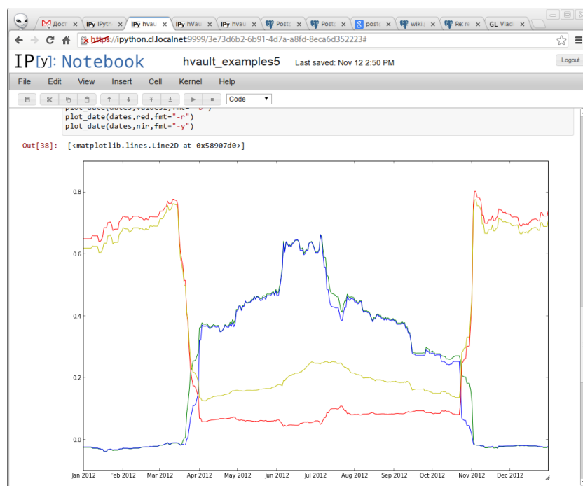
Рисунок 4. Сезонный ход вегетационного индекса (NDVI) в 2012 году для точки, расположенной на сельскохозяйственных угодьях в северо-западной части Алтайского края (синяя кривая). Желтая и красная кривые соответствуют значениям в красном и ближнем инфракрасном каналах. Индекс NDVI вычислен в том же запросе по формуле (NIR - R) / (NIR + R) . Данные извлечены из каталога данных TERRA/AQUA ЦКП ДДЗ СО РАН
